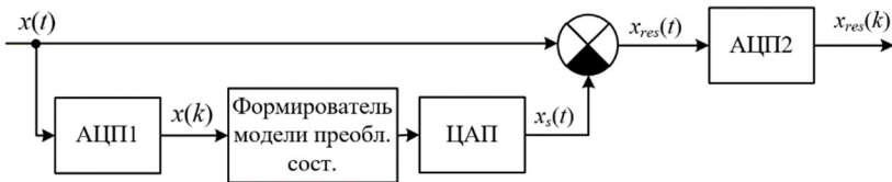
Рис. 2. Структурная схема тракта АЦП с активно-адаптивным распознаванием: x(t) – входной сигнал и его цифровой образ x(k) , x_s(t) – сигнал после ЦАП, x_{res}(t) – остаточный сигнал, содержащий ослабленную основную гармонику и высшие гармоники, и его цифровой образ x_{res}(k)
